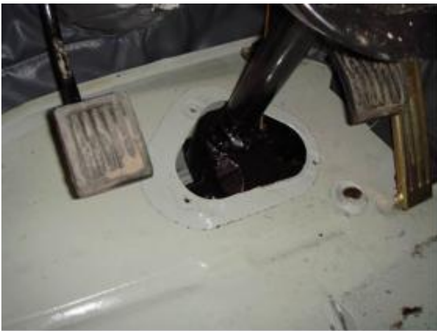
Штатное отверстие под рулевой механизм
