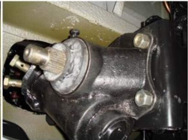
Крепление рулевого механизма к раме
