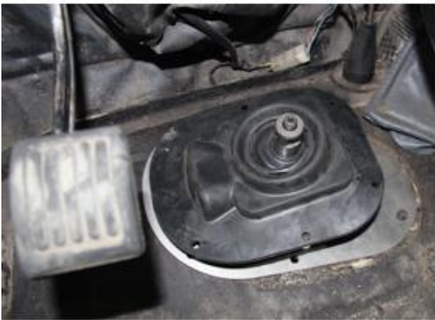
Вариант крепления резинового пыльника
