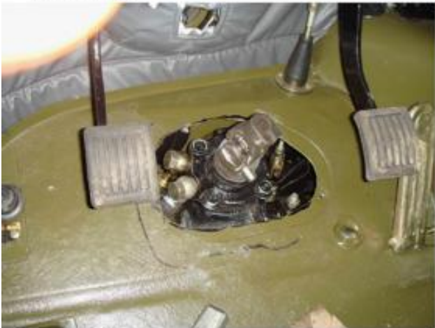
Рулевой механизм с карданчиком и шлангами
